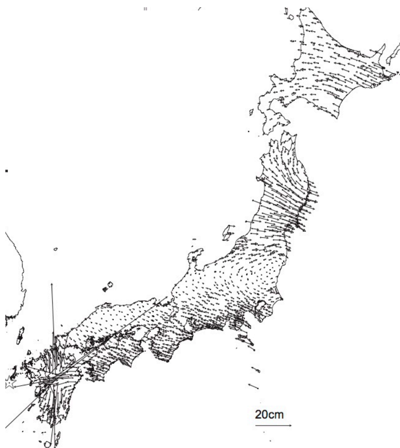
図 2015年8月から2016年6月の間の日本列島の地殻変動。右下に「20cm」の変動（水平）の大きさを示した。2011年の東北大震災と2016年4月14日の熊本地震の影響が見られる。熊本地震では1～2mもの変動があった。また東北大震災のぶり返しがみられる。
